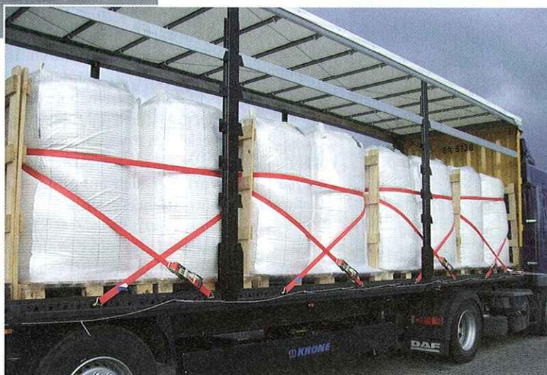
Methode: Sind die oben aufgeführten Vorgaben erfüllt, ist eine ausreichende Sicherung der Ladeeinheiten per Formschluss gegeben. Insbesondere bescheinigt das Eurosafe-Zertifikat, dass damit keine Verkehrsgefährdung von Dritten vorliegt, keine Gefahr der Beschädigung von Ware und Fahrzeug besteht und auch der Fahrzeugaufbau nicht destabilisiert wird.
