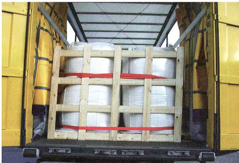
Die Gurte müssen in das Staugitter eingefädelt sein; zusätzlich sichert am Ladungsende eine Kopfschlinge im unteren Bereich.
